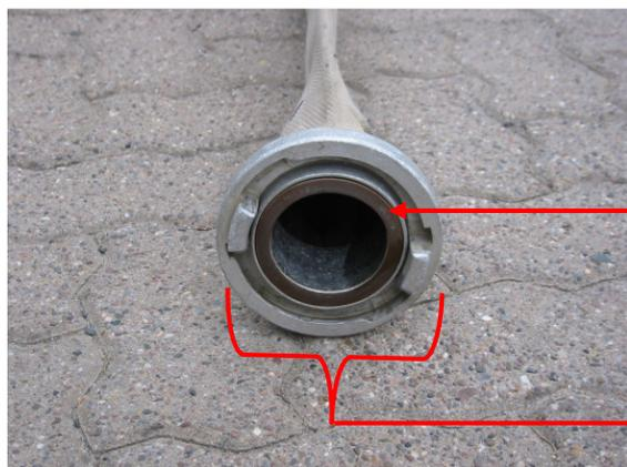
Dichtungsring einer Kupplung
