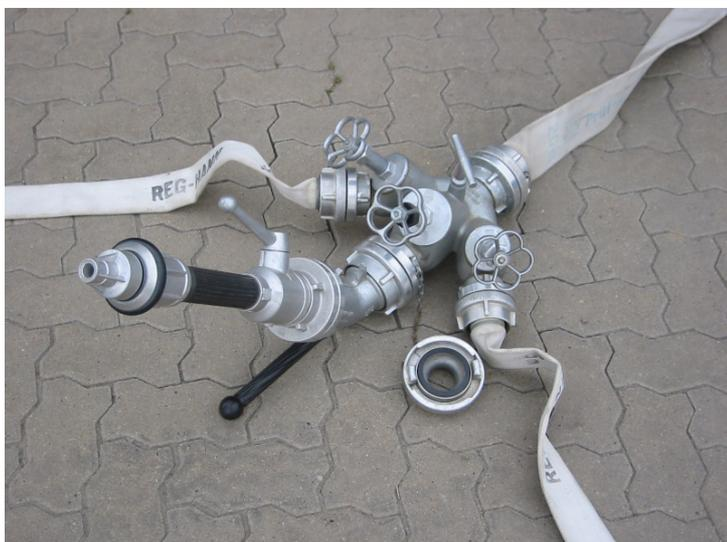
Verdeutlichung des, durch den Stützkrümmer, abgewinkelte B-Mehrzweckstrahlrohrs.
