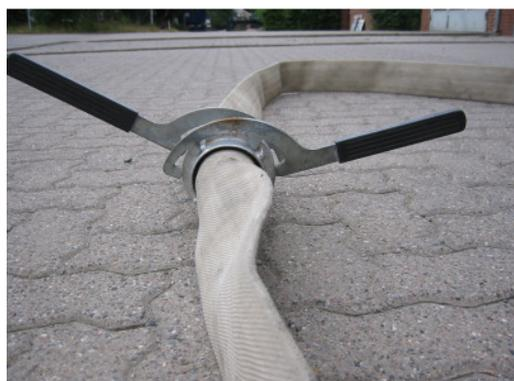
Kupplung fertig gekuppelt.
