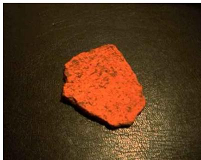
Dieses Bild zeigt ein Stück von einer Eisenoxid-Ablagerung.
